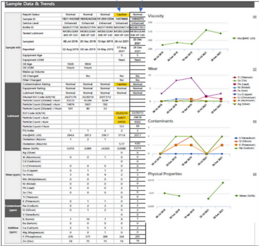
Gambar Contoh tampilan laporan teknis monitoring kondisi oli pada aplikasi MobilServ
