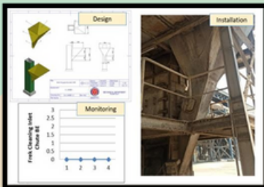
Instalasi lining hopper dengan wear resistance
